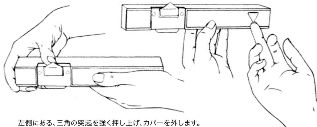
左側にある、三角の突起を強く押し上げ、カバーを外します。
